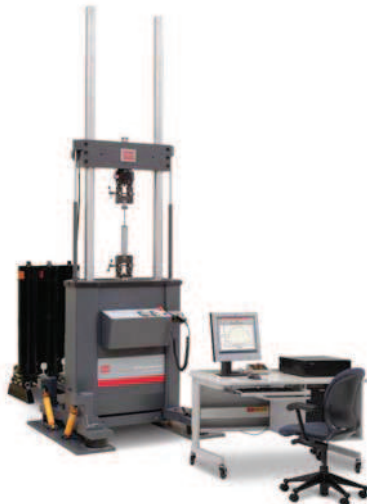
Fig. 1. MTS shock absorber test stand
