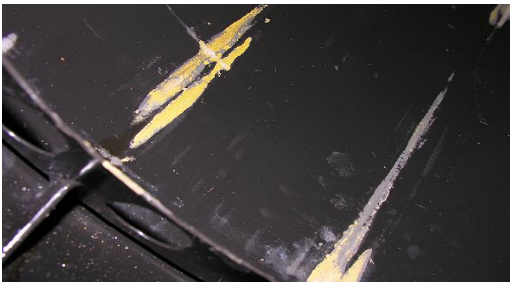
Fot. 5. Ślady przyklejenia powierzchni paliwa prochowego do komory spalania silnika startowego.
