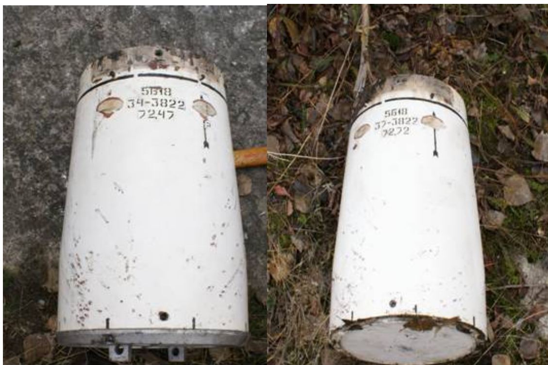
Fot. 3. Uszkodzenie mechaniczne powierzchni zewnętrznej głowicy bojowej.
