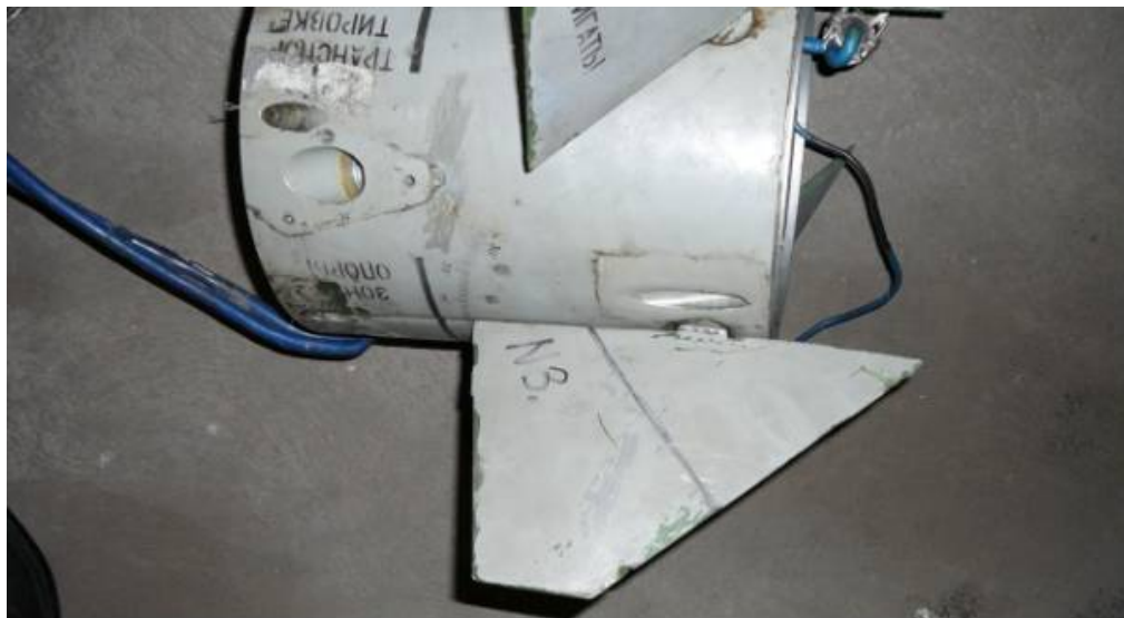
Fot. 2. Uszkodzenie mechaniczne powierzchni natarcia sterów.
