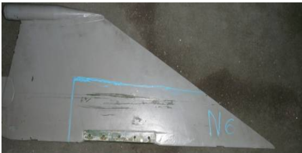
Fot. 1 Uszkodzenie mechaniczne powierzchni nośnej skrzydła.
