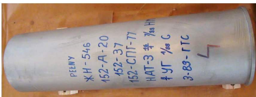
Fot. 8. Łuska stalowa od 152 mm ładunku pełnego z ręcznie naniesionym oznakowaniem [6]
