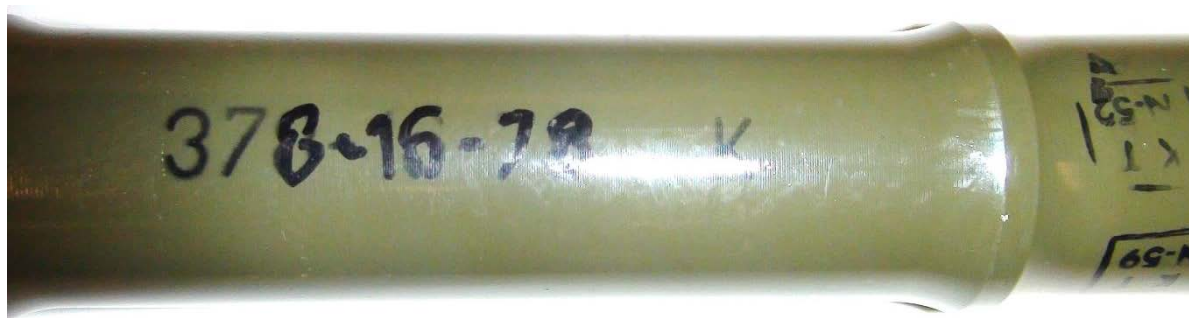
Fot. 10. Fragment silnika marszowego pocisku PG-7 z ręcznie naniesionym oznakowaniem [6] Photo. 10. Fragment of marching motor for PG-7 missile with hand made marking [6]
