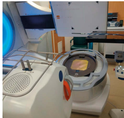
Ryc. 7 Układ pomiarowy – fantom CTDI 16 cm (pomiar dla pola referencyjnego)
