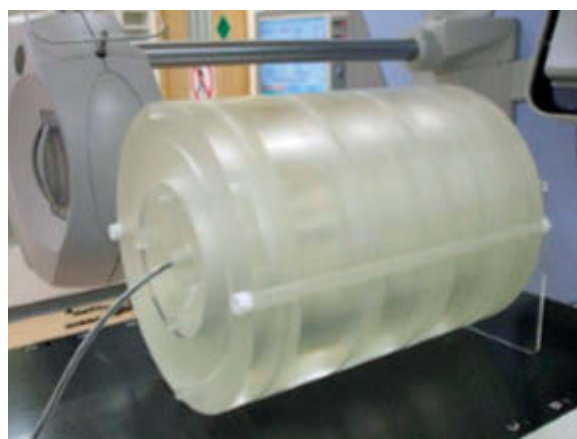
Ryc. 4 Fantom do pomiaru CTDI dla CBCT Źródło: [4].
