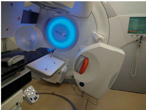
Ryc. 7 Układ pomiarowy – fantom CTDI 16 cm (pomiar dla pola referencyjnego)
