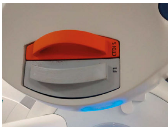
Ryc. 2 Kolimator CTDI-S o długości pola 20 mm umieszczony w prowadnicy osłony lampy RTG/XVI Źródło: Archiwum własne.
