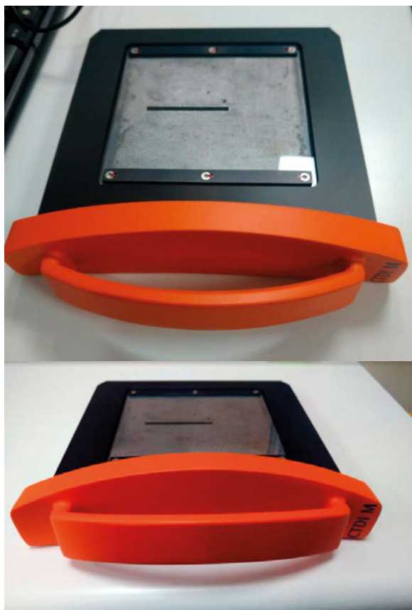
Ryc. 1 Kolimator CTDI-M, długość 20 mm Źródło: Archiwum własne.
