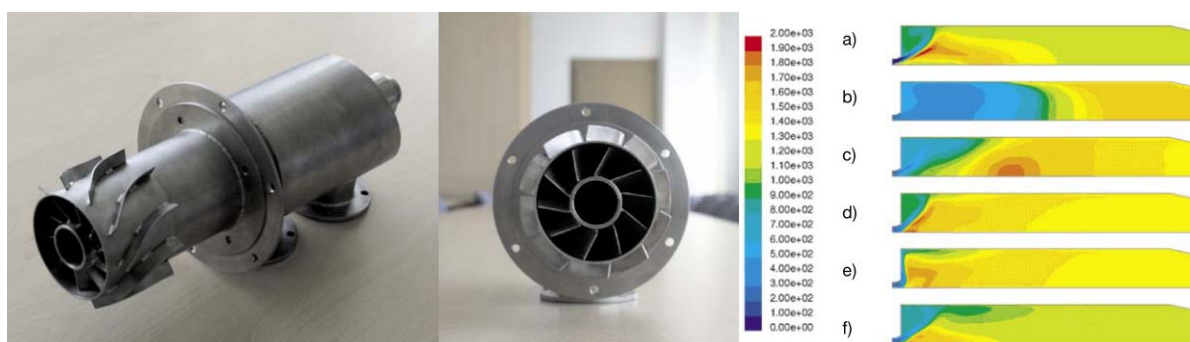
Rys. 1. Model laboratoryjny palnika wirowego na biomasę (po lewej) oraz wyniki analiz numerycznych rozkładu temperatur w okolicy płomienia dla różnych rozwiązań konstrukcyjnych (a – wariant bez zawirowania; b i c – kąt zawirowania powietrza pierwotnego, kolejno, 40° i 25°; d, e, f – stosowanie stabilizatorów mechanicznych na powietrzu pierwotnym) [2].
