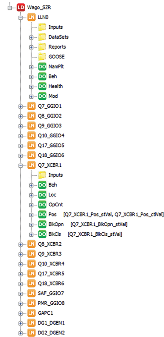
Rys. 6. Model danych dla układu SZR na serwerze MMS/IEC 61850 sterownika WAGO_RNN
