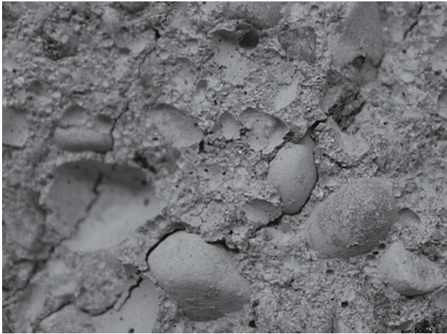
Rys. 2. Przełom próbki betonu po działaniu temperatury 600°C z widocznymi defektami technologicznymi w matrycy w okolicy kruszywa; widoczne ziarna kruszywa i linie zniszczenia
