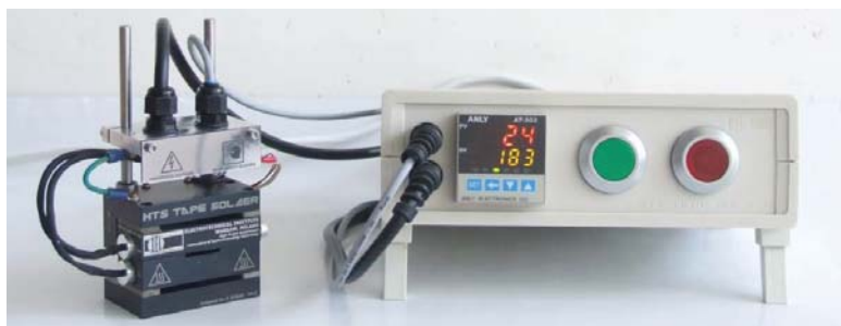
Rys. 2.38. Stacja lutownicza do wykonywania połączeń taśm HTS (Pracownia Technologii Nadprzewodnikowych IEL w Lublinie) [52]
