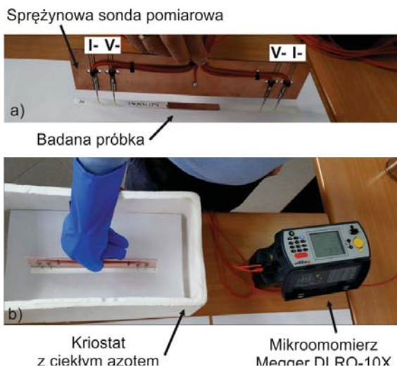
Rys. 2.41. Pomiary rezystancji połączeń miarkomierzem Megger DLRO-10X: a) w temperaturze pokojowej 300 K, b) w temperaturze 77 K
