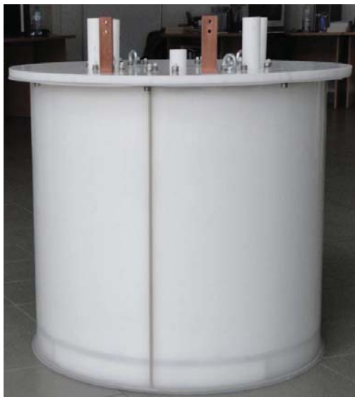
Rys. 6.18. Zmontowany nadprzewodnikowy ogranicznik prądu 6,9 kV / 600 A
