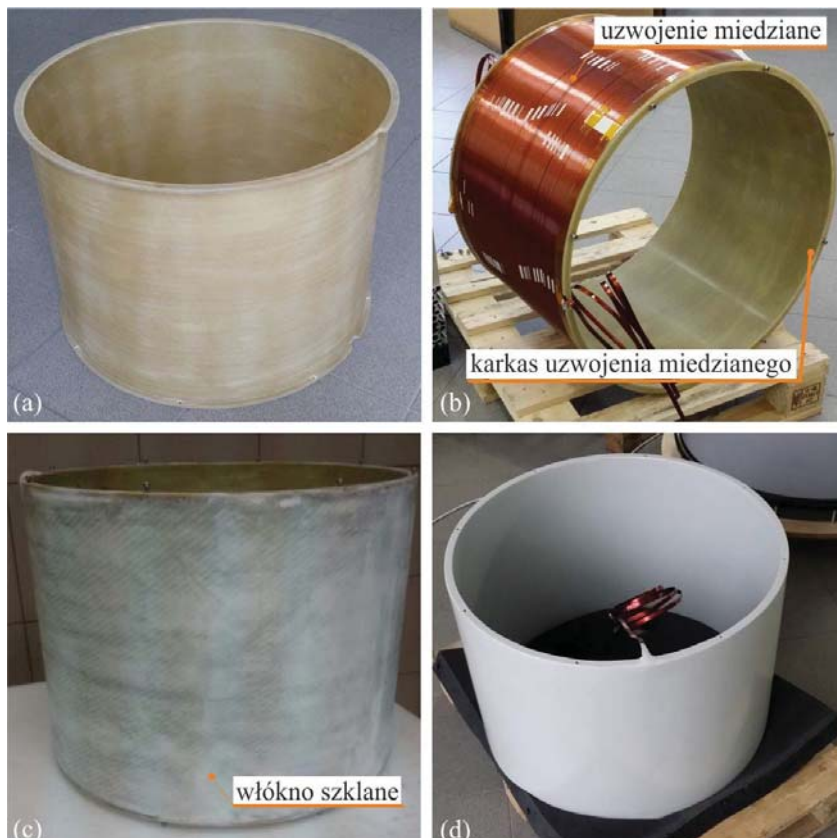
Rys. 7.7. Kolejne etapy wykonywania uzwojenia miedzianego ogranicznika:
