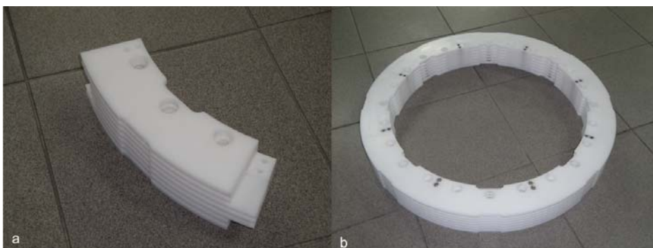
Rys. 6.2. Element karkasu uzwojenia pierwotnego (a), zmontowany karkas uzwojenia pierwotnego miedzianego jednego modułu ogranicznika (b)
