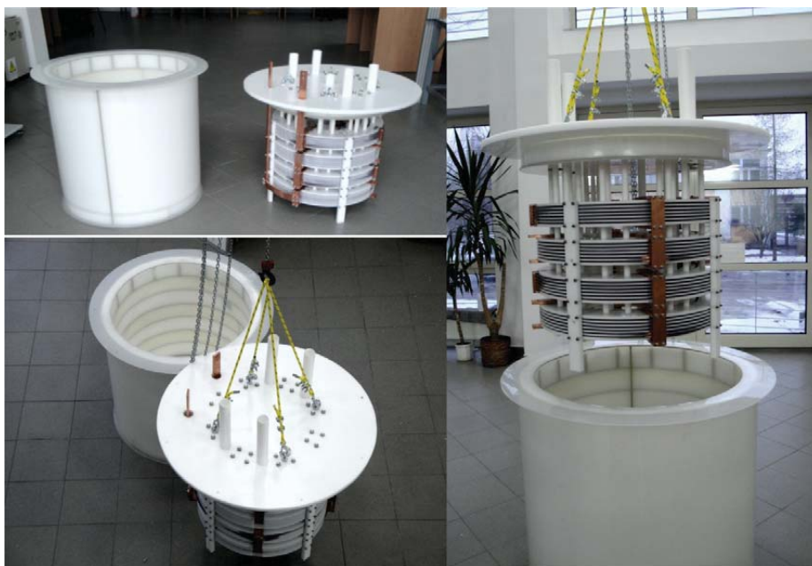
Rys. 6.17. Kriostat ogranicznika 6,9 kV / 600 A
