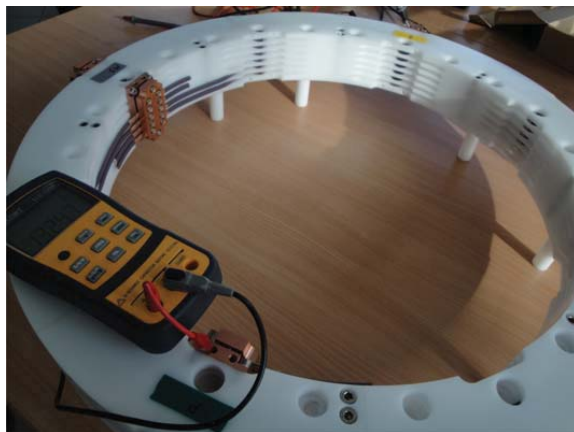
Rys. 6.33. Pomiar indukcyjności pierwotnych uzwojeń miedzianych ogranicznika mostkiem Escort ELC-133A
