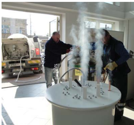
Rys. 6.40. Pierwsze chłodzenie ogranicznika ciekłym azotem
