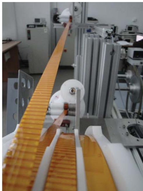
Rys. 6.9. Nawijanie z naciąganiem izolowanej taśmy HTS na karkas modułu ogranicznika
