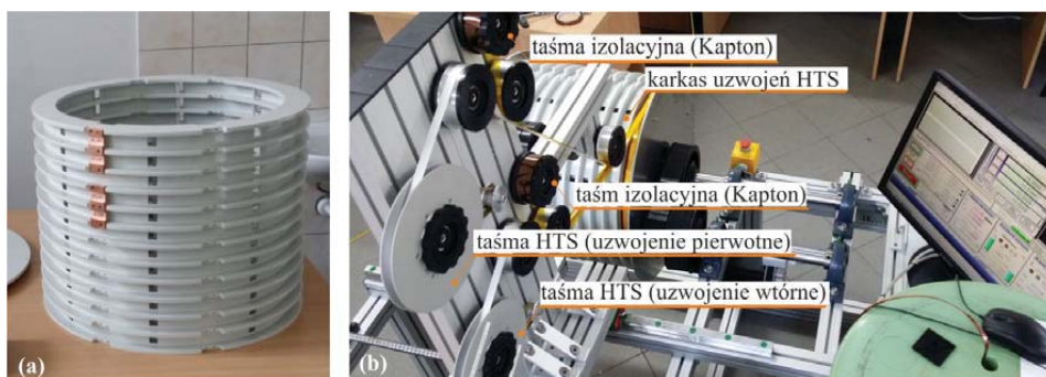
Rys. 7.5 a) Karkas uzwojeń nadprzewodnikowych ogranicznika wykonany z kompozytu epoksydowo-szklanego typu E, b) nawijanie dwóch cewek ogranicznika z jednoczesnym izolowaniem zwojów
