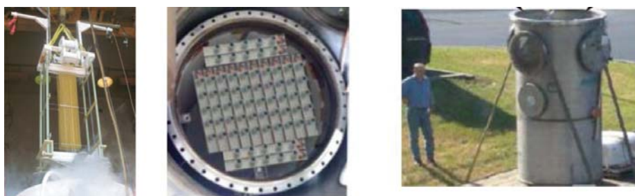
Rys. 5.3. Prototyp ogranicznika rezystancyjnego firmy SuperPower chłodzonego w kąpieli ciekłego azotu
