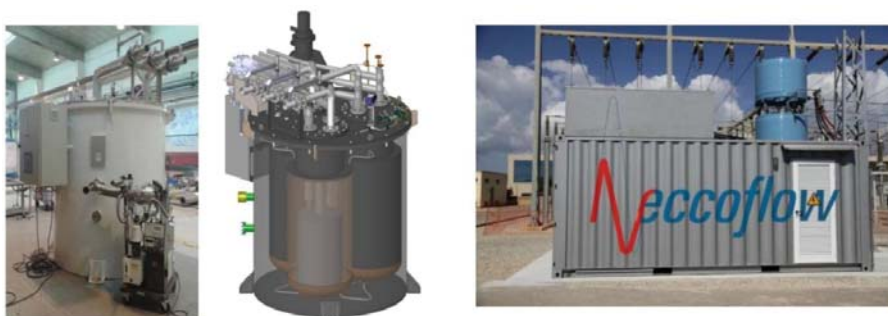
Rys. 5.2. Rezystancyjny ogranicznik prądu zwarciovego 24 kV, 1000 A [9], [19], [66]
