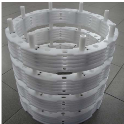
Rys. 6.6. Karkasy uzwojeń nadprzewodnikowych czterech modułów wykonane z TECAFORM-AH (POM-C)
