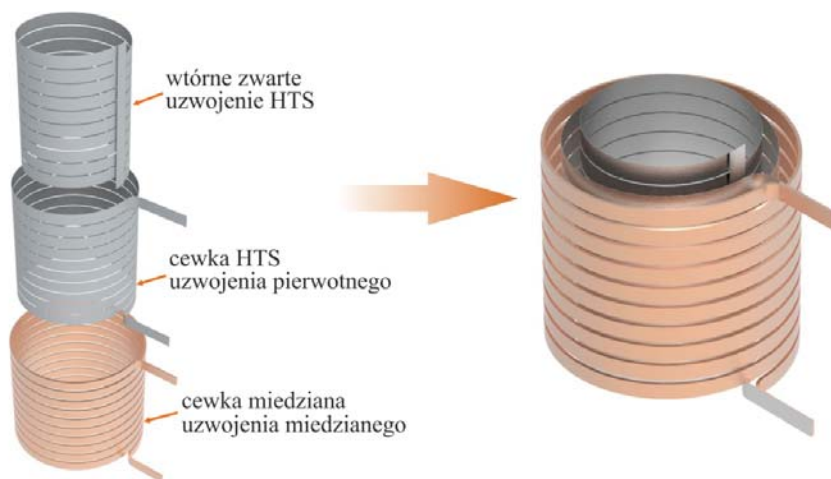
Rys. 5.12. Trójuzwojeniowy bezrdzeniowy nadprzewodnikowy ogranicznik prądu typu indukcyjnego
