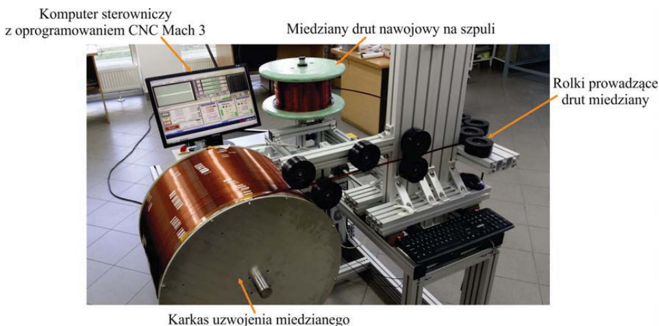
Rys. 7.9. Proces nawijania uzwojenia miedzianego na karkas z kompozytu epoksydowo-szklanego
