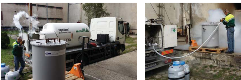
Rys. 7.60. Chlodzenie nadprzewodnikowego ogranicznika pradu przed wykonaniem testow zwarciovych
