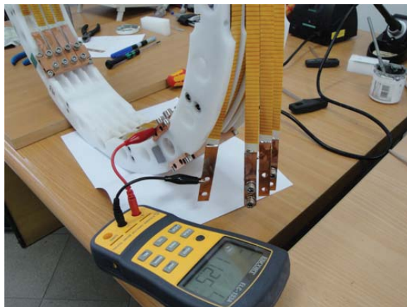
Rys. 6.34. Pomiar indukcyjności cewek uzwojenia nadprzewodnikowego ogranicznika mostkiem Escort ELC-133A
