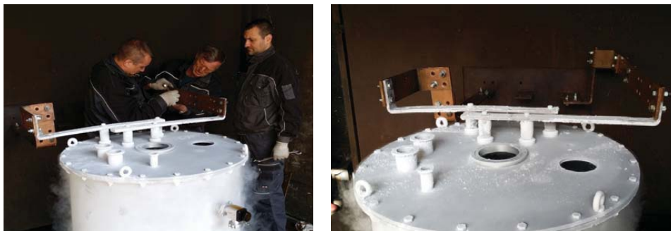
Rys. 7.61. Łączenie schłodzonego ogranicznika prądu z obwodem zwarciovym
