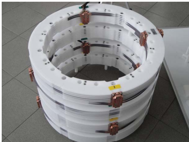
Rys. 6.4. Pierwotne uzwojenia miedziane ogranicznika 6,9 kV / 600 A złożone z czterech modułów po zamontowaniu miedzianych bloków połączeniowych
