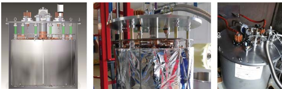
Rys. 5.4. Prototyp ogranicznika rezystancyjnego chłodzonego kontaktowo (konsorcjum: Instytut Elektrotechniki, Uniwersytet Zielonogórski, Frako-Term sp. z o.o.)
