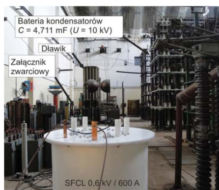
Rys. 6.41. Układ zwarciovoy z włączonym szeregowo ogranicznikiem 6,9 kV / 600 A
