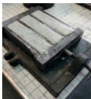
Rys. 1. Badane próbki w czasie formowania i przygotowane do badań
