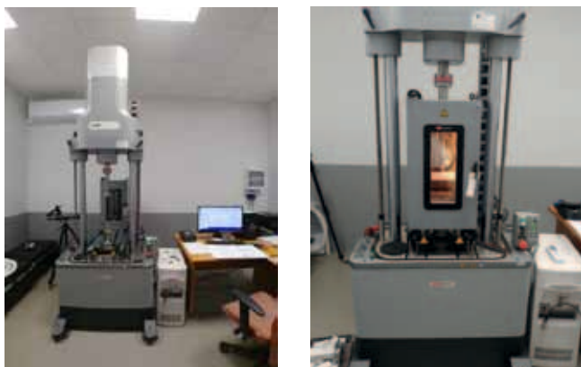
Rys. 2. Maszyna wytrzymałościowa Instron ElectroPuls E10000 wraz z komorą termiczną
