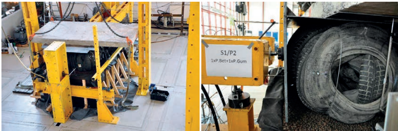
Rys. 3. Badanie oporów ścinania: widok stanowiska (po lewej), miejsce przyłożenia poziomej siły ścinającej (z prawej)
