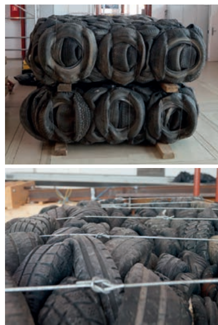
Rys. 2. Pakiety SZOS (góra) oraz połączenie drutów spinających pakiety (dół)
