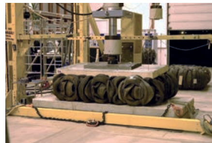
Rys. 6. Zniszczenie stanowiska ze względu na nierównomierną deformację pakietu, której skutkiem jest przechylenie płyty dociskowej w końcowym etapie badań
