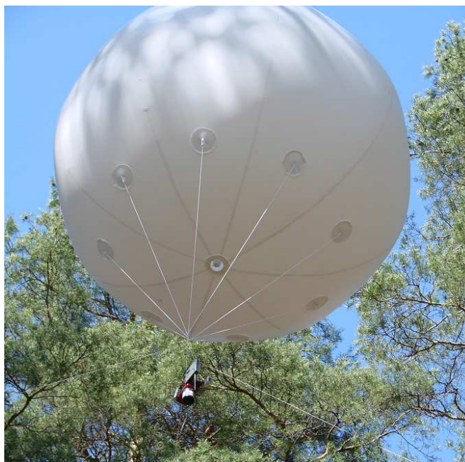
Fot. 2. Balon helowy z podwieszonym fotoaparatem
