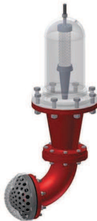
Rys. 2. Widok 3D gaśnicy testowej o objętości 10 dm 3 [5] Fig. 2. 3D view of the tested fire extinguisher of 10 dm 3 in capacity
