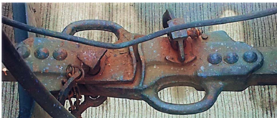
Rys. 1. Widok przestrzenny i zdjęcie sprzęgu tramwajowego (sprzęgu Alberta)
