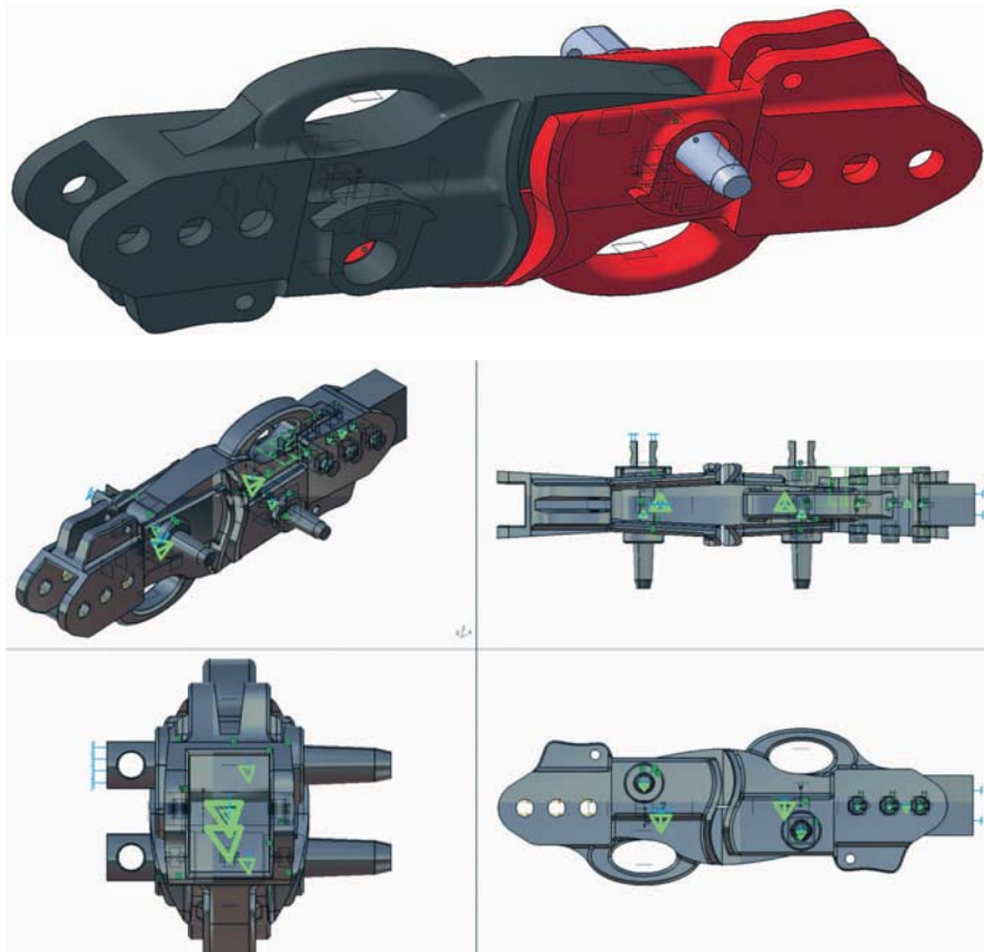
Rys. 3. Widok modelu 3D sprzęgu tramwajowego w systemie CATIA V5
