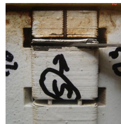
Rys 1. Rozwarstwienie blach w części zębowej skrajnych pakietów rdzenia stojana TG – faza I uszkodzeń
