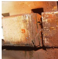
Rys. 3 Uszkodzenia (ubytki blach) skrajnych zębów rdzenia stojana TG – faza 3
