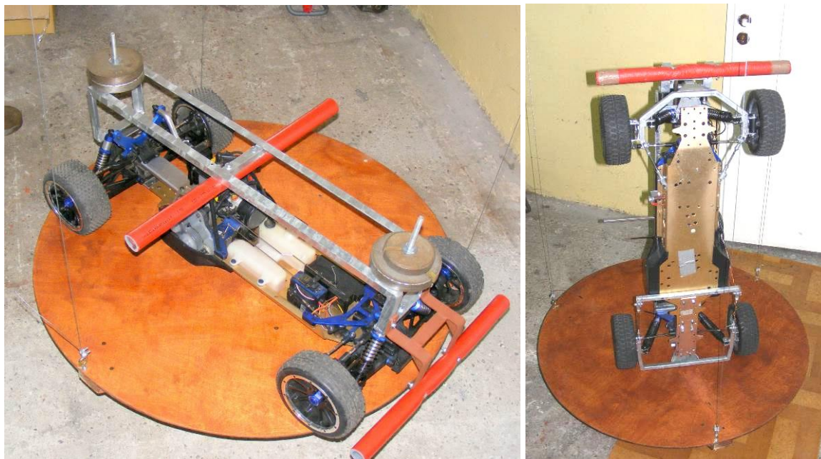
Rys. 4. Pomiar momentów bezwładności mobilnego modelu pojazdu
