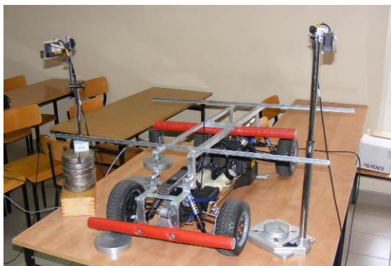
Rys. 7. Pomiar sztywności przechyłowej K_\phi oraz tłumienia D_\phi zawieszek
