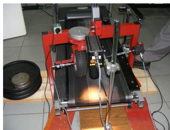
Rys. 6. Pomiar sztywności kątowej C_{\alpha} opony modelu na bieżni do badań opon
