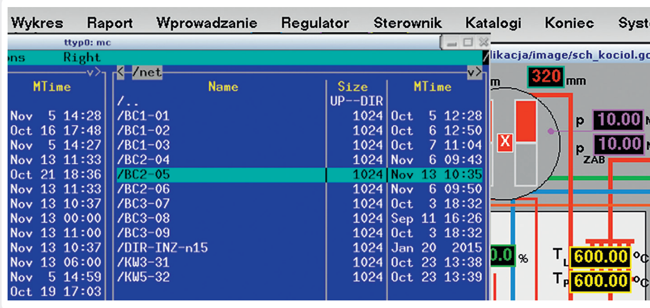
Rys. 5. Protokół QNX6-Qnet – przezroczysty dostęp do plików stacji operatorskich w sieci lokalnej
