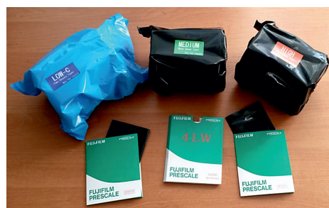
Rys. 4. Zestaw folii FujiFilm Prescale użyty do badań [9] Fig. 4. Fuji Prescale film set used for investigation [9]
