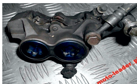
Rys. 3. Zacisk hamulcowy motocykla Yamaha FZS 600 [10] Fig. 3. Brake caliper of Yamaha FZS 600 motorcycle [10]
