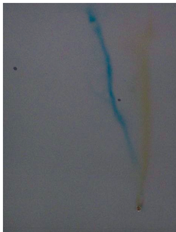
Rysunek 21. Pasmowe rozdzielanie dwuskładnikowej mieszaniny barwników metodą OPPEC
