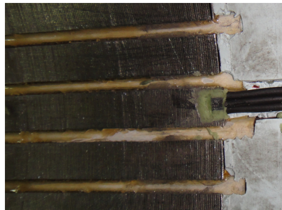
Rys. 4. Jeden z hallotronów zamocowany w zębie stojana
