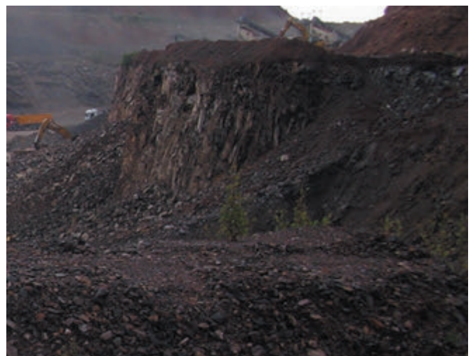
Rys. 2. Wyrobisko złoża „Targowica”. Fragment wewnętrznej części potoku lawowego z bazaltami wykazującymi cios słupowy Fig. 2. The Targowica quarry. A part of the inner zone of a basalt flow revealing columnar jointing
