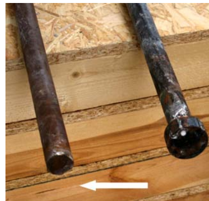
Ryc. 9. Urwany łeb szpilki Fig. 9. Pin head torn off
