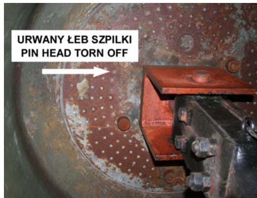
Ryc. 8. Szpilki widoczne od spodu hełmu Fig. 8. Pins seen at the bottom of bell shoulder
