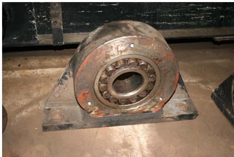
Ryc. 27. Łożysko podporowe z obudową Fig. 27. Support bearing with its casing
