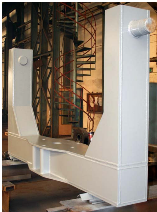
Ryc. 29. Widok jarzma zabezpieczonego podkładem antykorozyjnym Fig. 29. Yoke protected with anti-corrosion substrate
