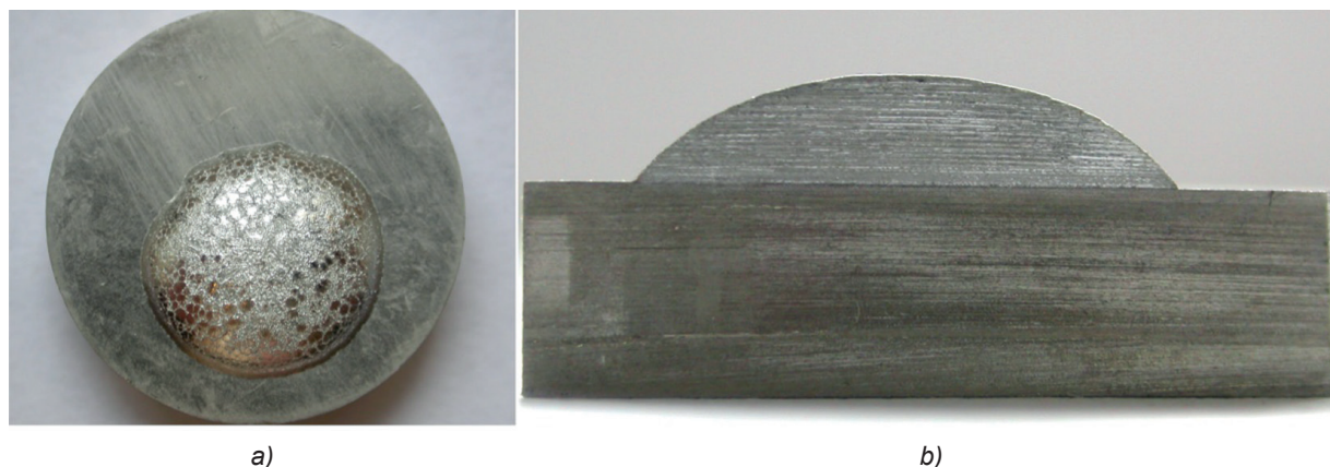
Rys. 4. Próbkę SAC305/Ni-11,6P/Ni po badaniach zwilżalności w T = 230^{\circ}\text{C} , t = 5 min: a) widok z góry, b) widok poprzecznego przekroju próbki
