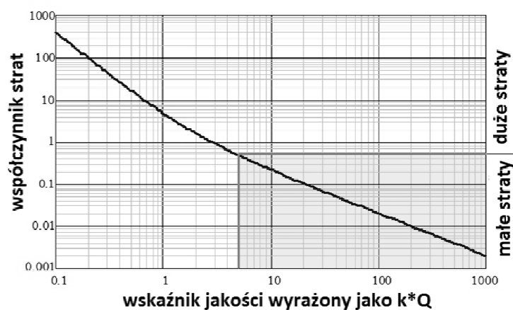
Rys. 2. Charakterystyka ilości strat w zależności od jakości sprzężenia i dobroci [3]
