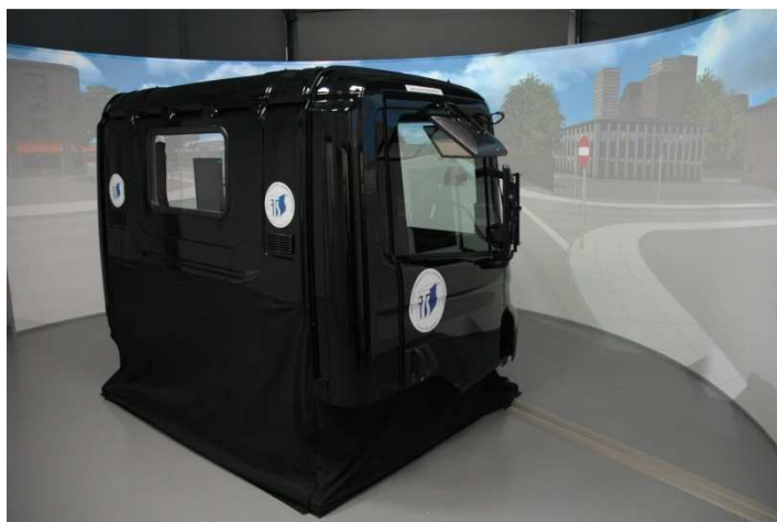
Rys. 2. Symulator samochodu ciężarowego i autobusu AS1300 (Źródło: Zbiory własne ITS)
