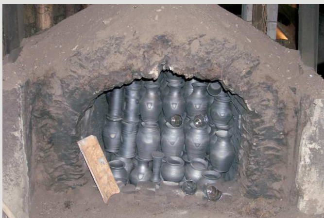
Fot. 1. Piec do wypału siwaków z paleniskiem z tyłu w Czarniej Wsi Kościelnej (własność Jana Kurdewicza)
