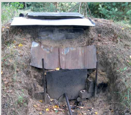
Fot. 6. Piec do wypału czarnej ceramiki z paleniskiem z przodu w Pelekiškė (własność Teresė Jankauskaitė)
