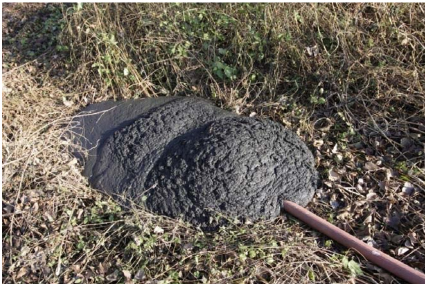
Fot. 1. Wydobyty osad denny o konsystencji zaprawy betonowej (fot. K. Wierzbicki)
