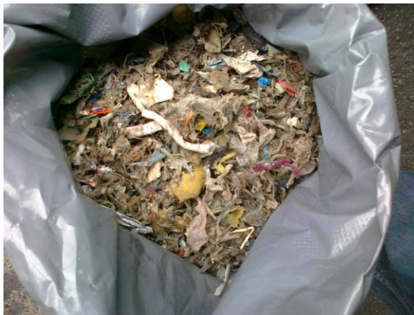
Rys. 2.1.1. Wygląd ogólny SRF pochodzącego z REMONDIS Dąbrowa Górnicza (fot. R. Wasielewski)
