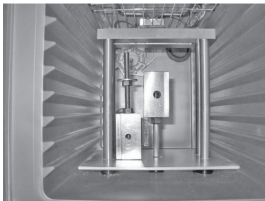
Ryc. 11. Próbkę przed badaniem ścinania umieszczoną w specjalnych uchwytach urządzenia
