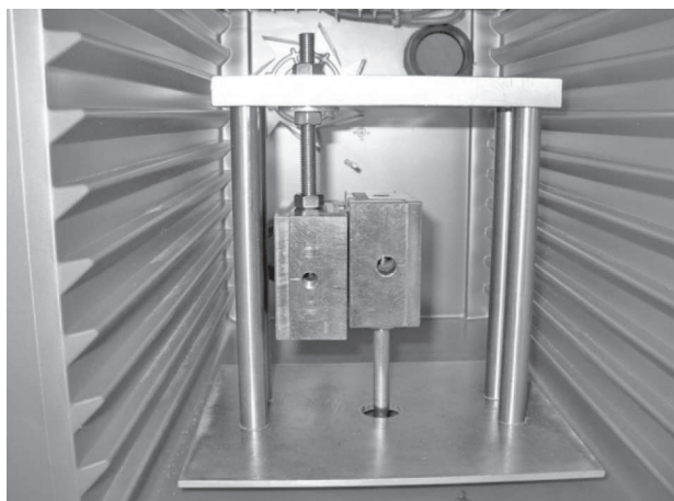
Ryc. 12. Próbkę po badaniu ścinania umieszczoną w specjalnych uchwytach urządzenia
