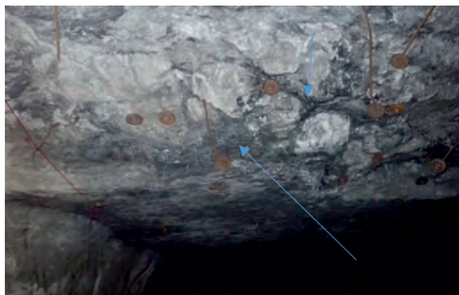
Fig. 16. Stanowisko 3. Kowelin, chalkozyn, bornit, zanikające w stropie wyrobiska –oznaczone strzałkami (fot. P. Zdobyłak)
