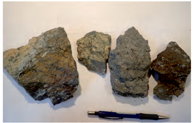
Fig. 10. Przykłady mineralizacji na stanowisku 1 (kolejno: chalkopiryt, piryt, wapień z galeną, chalkopiryt) (fot. P. Zdobylak) Fig. 10. Position 1. Chalcopyrite, pyrite, Limestone with Galena, Chalcopyrite (from left to right)
