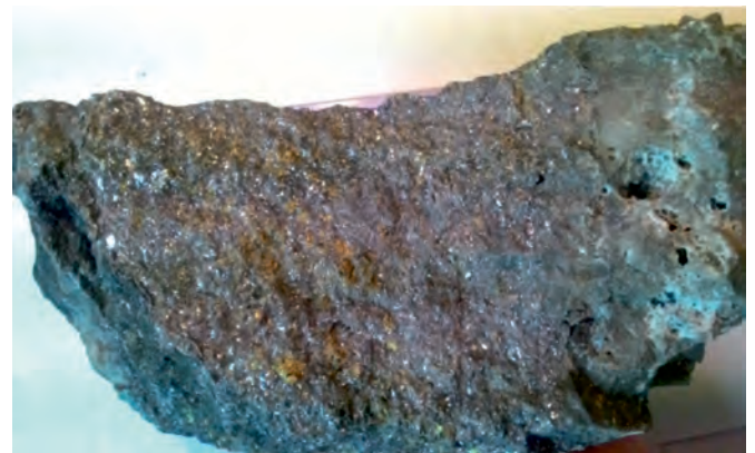
Fig. 25. Galena z chalkopirytym i pirytem w porowatym wapieniu - strefa „3” (Fig.1) (fot. P. Zdobyłak)
