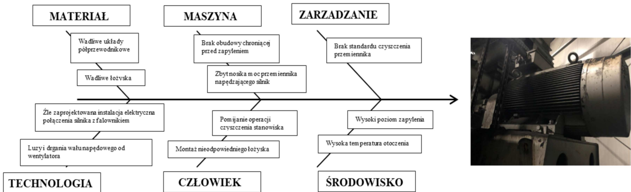
Rys. 6. Diagram Ishikawy uszkodzenia filtra dużego.
