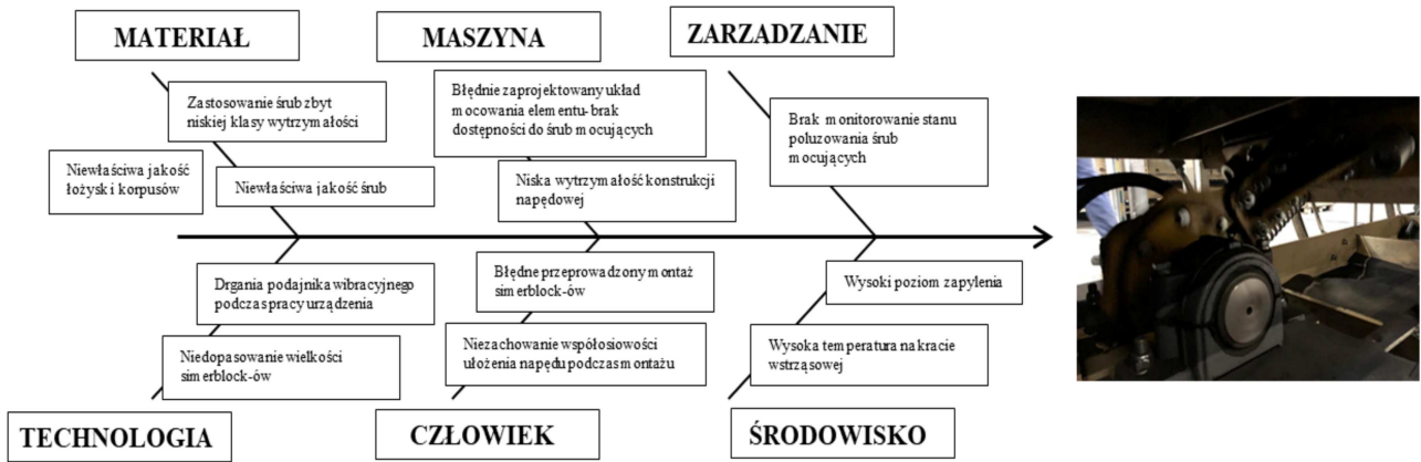
Rys. 5. Diagram Ishikawy uszkodzenia ryny wibracyjnej.
