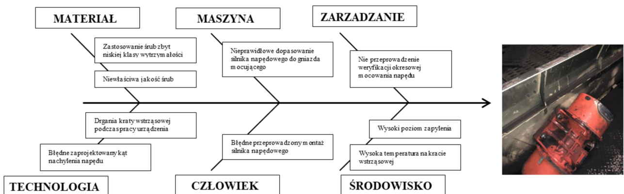
Rys. 4. Diagram Ishikawy uszkodzenia silnika napędowego.
