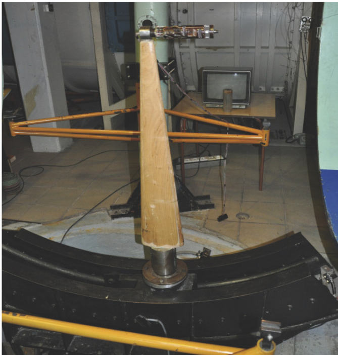
Rys. 5. Stanowisko pomiarowe. U góry masztu widoczna waga WDP-01 [W. Strycniewicz, 2015]
