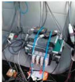
Rys. 2. Zestaw aparatury (a- kierownica dynamometryczna, b- urządzenie przetwarzająco-rejestrujące AD32) oraz przykładowy widok toru badawczego (droga o nawierzchni beto-nowej z obniżonym poboczem gruntowym -c)
