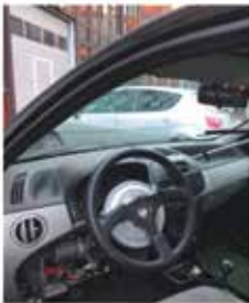
Rys. 2. Zestaw aparatury (a- kierownica dynamometryczna, b- urządzenie przetwarzająco-rejestrujące AD32) oraz przykładowy widok toru badawczego (droga o nawierzchni beto-nowej z obniżonym poboczem gruntowym -c)
