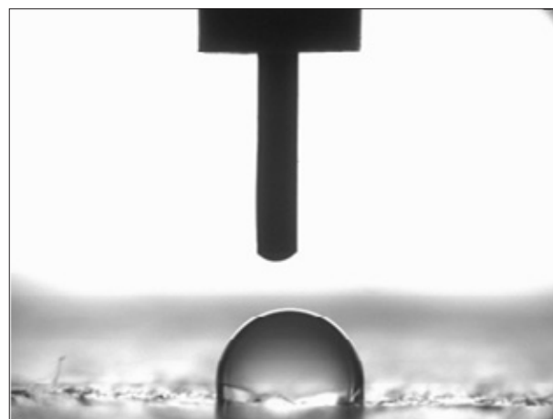
Rys. 5. Obraz kropli wody destylowanej osadzonej na powierzchni kompozytu 4B
