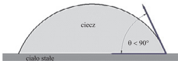
Rys. 2. Graficzne przedstawienie kąta zwilżania Fig. 2. Graphical representation of the contact angle
