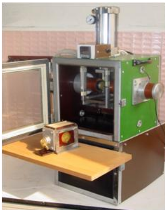
Rys. 1. Stanowisko do badań ultradźwiękowych kinetyki utwardzania mas ze spoiwami chemicznymi [6, 12]
