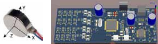
Rys.12. Od lewej od góry: zastosowany mikrowzбудnik DC, układ sterowania, widok rękawa model 1, widok rękawa model 2.
