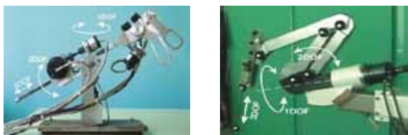
Rys. 5. Widok czujników MEMS na zadajniku operatora (a) i ramieniu robota Robin Heart (b) płytka elektroniczna z ADXRS150 (c).
