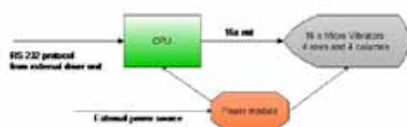
Rys. 13. Schemat blokowy układu sterowania
