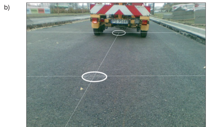
Fot. 2. Widok przekrojów pomiarowych do metod: a) VSS, b) FWD
