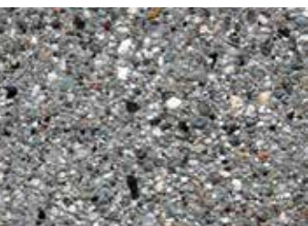
Fot. 11. Powierzchnia wypłukana na kruszywie 2–8 mm (żwir), szare zabarwienie zaprawy
