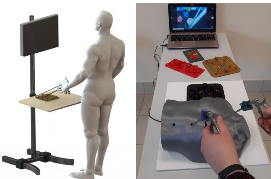
Rys.7. Rodzaje treningu na тренаżerze: trening na samym zestawie ćwiczeniowym - wizualizacja wykonana w programie SolidWorks2020 (z lewej), trening na stanowisku z kamerą (z prawej)
