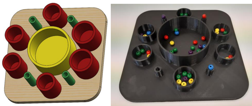
Rys.3. Zestaw ćwiczeniowy do chwytania obłych kształtów: wizualizacja wykonana w programie SolidWorks2020 (z lewej), model fizyczny (z prawej)
