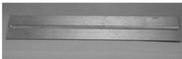
Rys. 3. Złącze doczołowe wykonane metodą FSW
