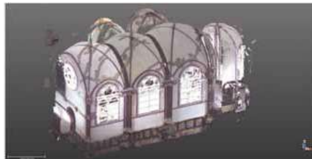
Rys. 15. Model 3D kościoła na bazie przeprowadzonych pomiarów wewnątrz obiektu
