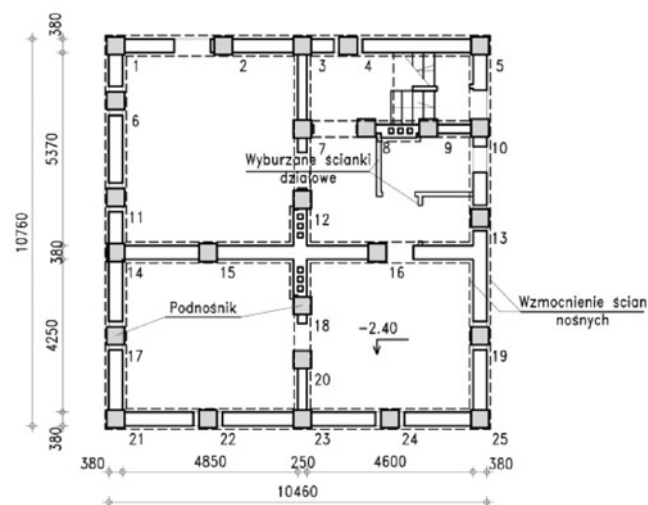
Rys. 7. Przykładowe rozmieszczenie w budynku jednorodzinym podnośników sterowanych przemieszczeniem (metoda DMT)
