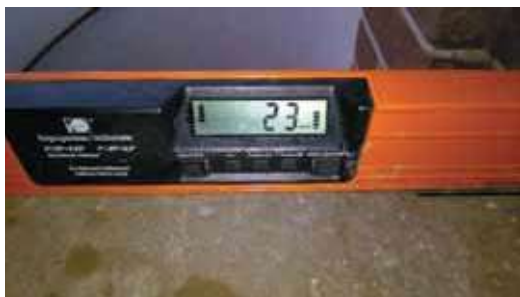
Rys. 16. Przykład pomiaru pochylenia poziomu elementu kościoła przed rektyfikacją (27.01.2015 r.)
