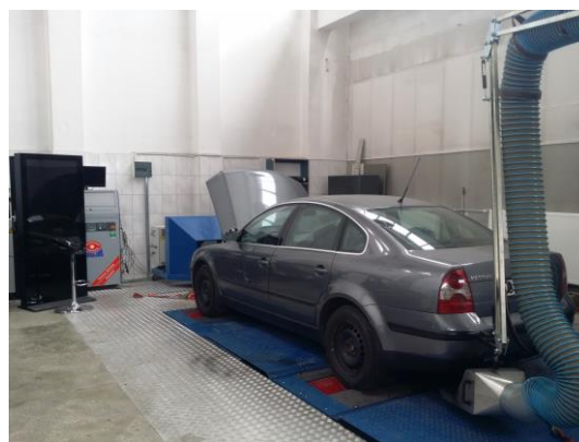
Rys. 1. Pojazd osobowy VW Passat zamocowany na hamowni podwoziowej MAHA MSR 500
