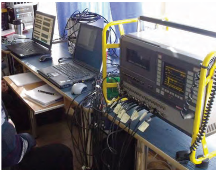
Fot. 5. Stanowisko Instytutu Lotnictwa do analizy danych w czasie prób flutterowych
