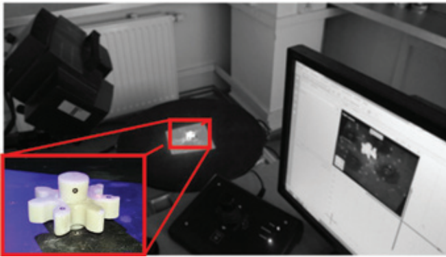
Rys. 3. Skanowanie koła zębatego za pomocą systemu optycznego ATOS Triple Scan II Blue Light
