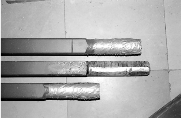
Fot. 7. Styki montażowe i końcówki ściągow
