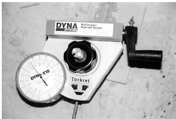
Fot. 17. Próba nośności kotwy na wyrywanie. Zarejestrowana siła 7,4 kN
