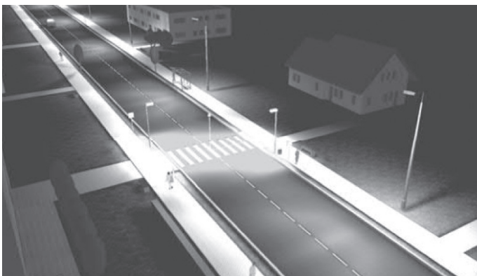
Rys. 5. Przykład przejścia dla pieszych z zastosowanym dodatkowym oświetleniem Źródło: [13]
