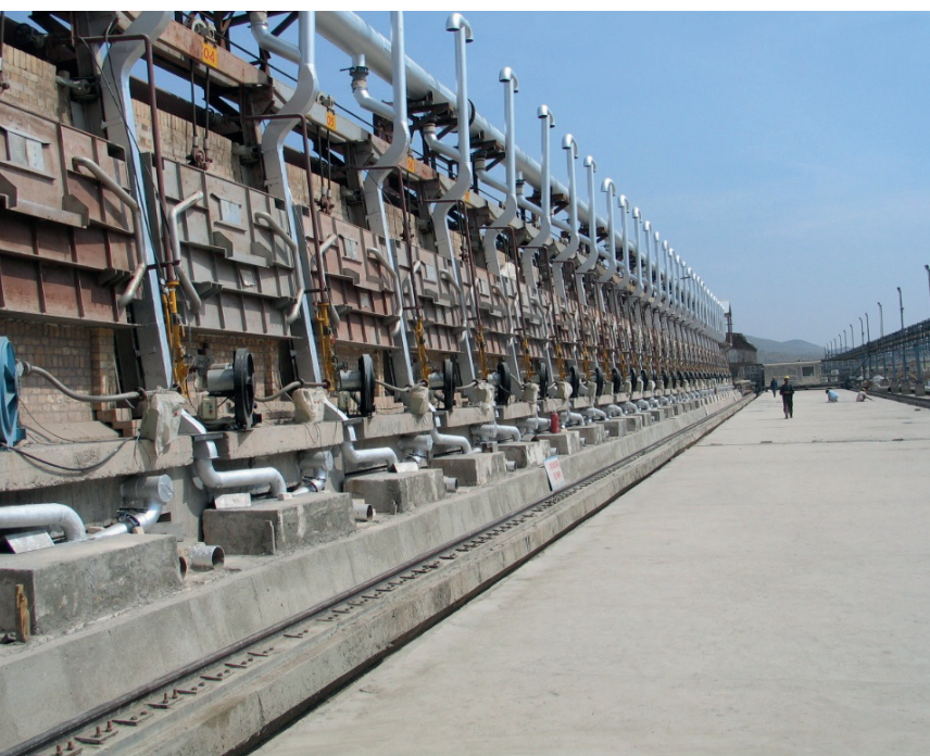
Rys. 6. Zdjęcie baterii dwuproduktowej pracującej w wersji z odprowadzeniem spalin rurociągami poniżej poziomu komór do kotła odzysknicowego (źródło SESA GOA).
