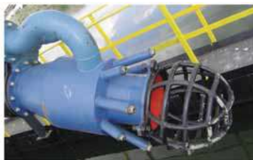
Rys. 2. Wydobywanie kopalini piaskowo-żwirowej spod wody; a) pływająca koparka ssąca (fot. K. Guzik), b) głowica zruszająca (fot. W. Glapa)
