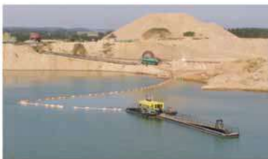
Rys. 2. Wydobywanie kopalini piaskowo-żwirowej spod wody; a) pływająca koparka ssąca (fot. K. Guzik), b) głowica zruszająca (fot. W. Glapa)
