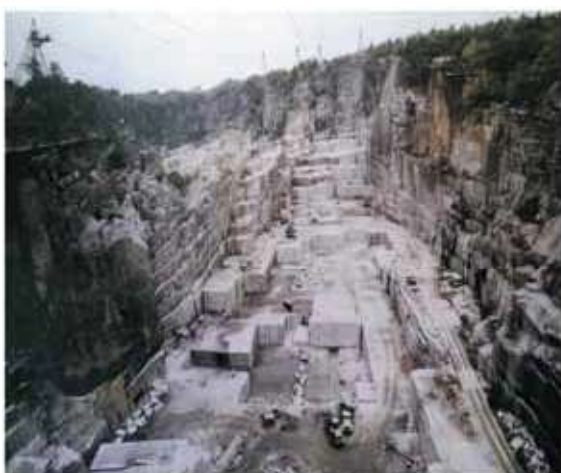
Rys. 11. Widok ogólny wyrobiska Borów 14: a) koniec lat 90. – transport pionowy dźwignicami linotorowymi, b) 2017 rok – transport z dolnej części wyrobiska derrickiem oraz pochylniami z górnych poziomów eksploatacyjnych
