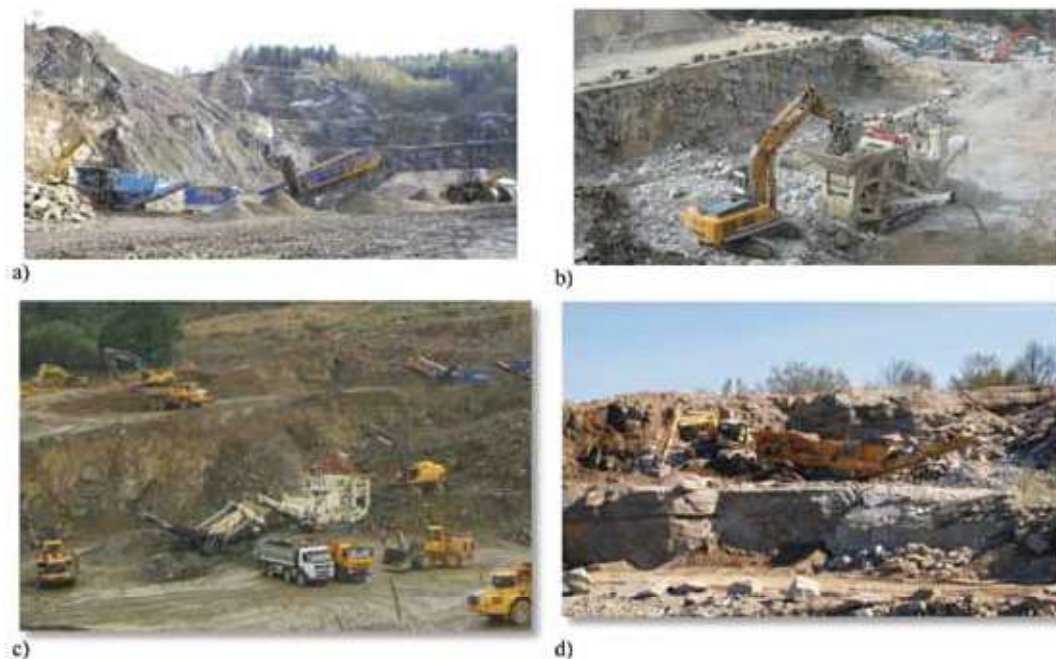
Rys. 4. Przykłady układów wydobywczych K/Ł–LT–Ł–S; a) wydobywanie i produkcja kruszyw na poziomie eksploatacyjnym w małej kopalni piaskowca, b) lokotrack współpracujący z mobilnym zakładem produkcji kruszyw w wyrobisku (I etap rozbudowy Kopalni Granitu Wieśnica), c) mobilne układy w trakcie udostępniania kopalni kruszyw łamanych w Piławie Górnej, d) układ K–LT–S w selektywnej eksploatacji partii nadkładowych złoża Wieśnica (fot. M. Stefanicka, T. Wojtaszek) Fig. 4. Examples of K/Ł–LT–Ł–S mining systems; a) mining and production of crushes on exploitation level in small sandstone mine, b) lokotrack contributing with mobile crushers processing plant in open cast (first stage of Wieśnica Granite Mine expansion), c) mobile plants during startup of the crushed aggregates mine in Piława Górna, d) K–LT–S system in selective exploitation of overburden parts of Wieśnica deposit (photo by M. Stefanicka & T. Wojtaszek)
