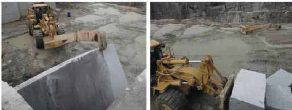
Rys. 12. Przykłady zastosowania ładowarki kołowej z wymiennym osprzętem CAT 988 H: a) „obalanie” bloku zgarniakiem na poziom eksploatacyjny, b) transport bloku ładowarką z osprzętem widłowym (fot. M. Stefanicka)
