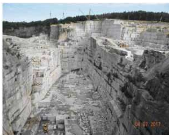
Rys. 11. Widok ogólny wyrobiska Borów 14: a) koniec lat 90. – transport pionowy dźwignicami linotorowymi, b) 2017 rok – transport z dolnej części wyrobiska derrickiem oraz pochylniami z górnych poziomów eksploatacyjnych
