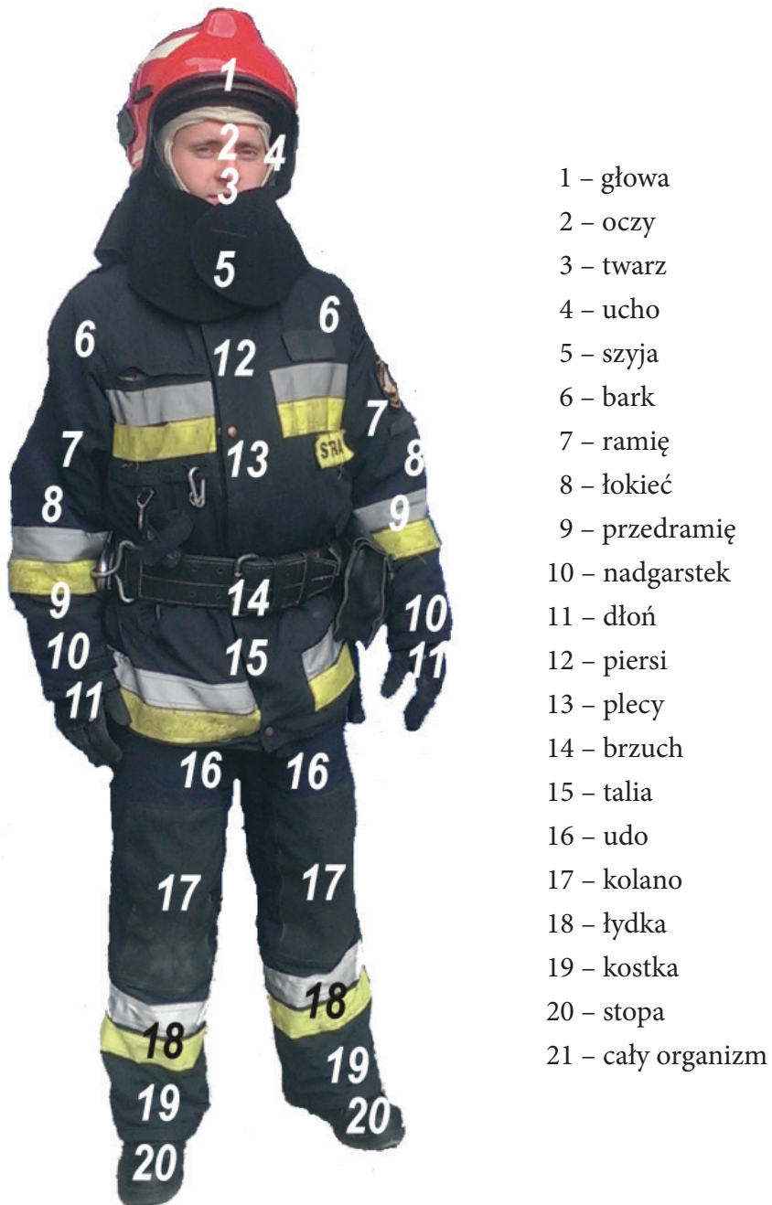
Rys. 5. Przyjęty dla warunków krajowych model stref potencjalnych zagrożeń ratownika w standardowych środkach ochrony indywidualnej
