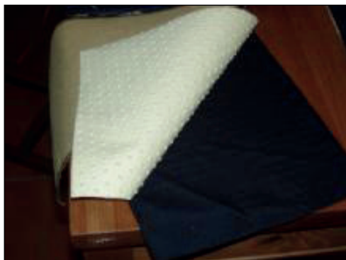
Rys. 2. Przykład zestawu warstw materiałów odzieży ochronnej
