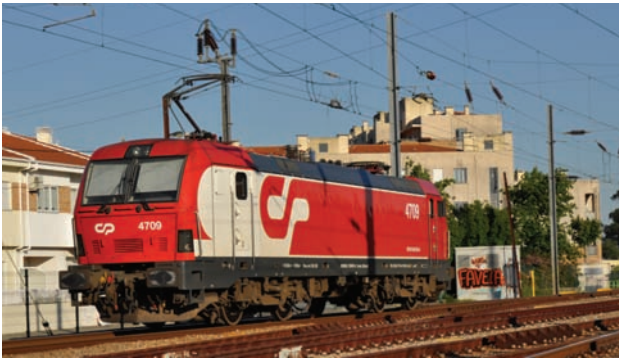
Rys. 4. Lokomotywa serii LE 4709 (1668 mm, 25 kV 50 Hz) na stacji Valongo (Estação), Portugalia (21.06.2010 r.) [fot. T. Miranda / Wikimedia Commons]
