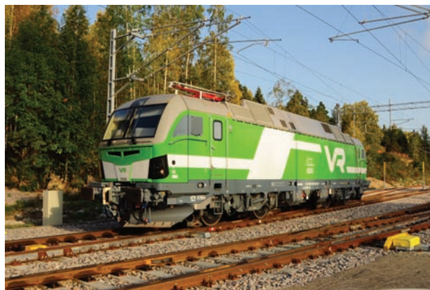
Rys. 23. Lokomotywa Vectron VR 3306 (1524 mm, 25 kV 50 Hz) na stacji Vanha Asema, Finlandia (27.09.2017 r.) [fot. P. Trippi]
