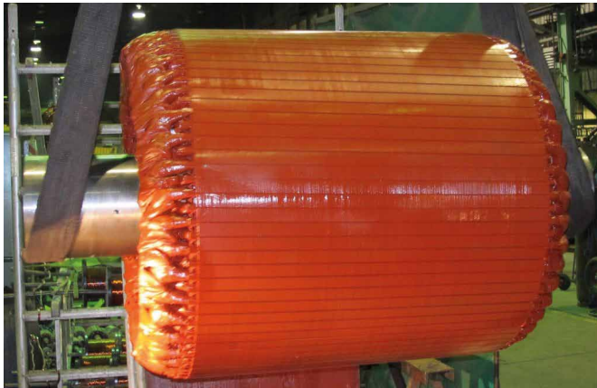
Rys. 2. Uzwojony pakiet stojana silnika PMSM
