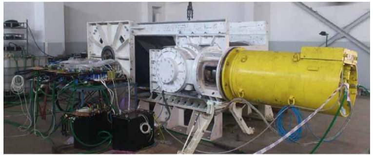
Rys. 3. Stanowisko badawcze bezprzekładniowego napędu górniczego przenośnika taśmowego
